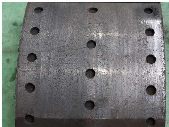
写真 2-3 ブレーキライニング
